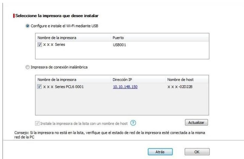
**Nota:** Cuando cambie la dirección IP de la impresora instalada mediante el driver con el ID de host, puede también imprimir directamente si necesita reinstalarlo. Si necesita instalar el driver de la impresora con el ID de host, por favor, marque la opción “Instalar la impresora en lista con el ID de host”.
